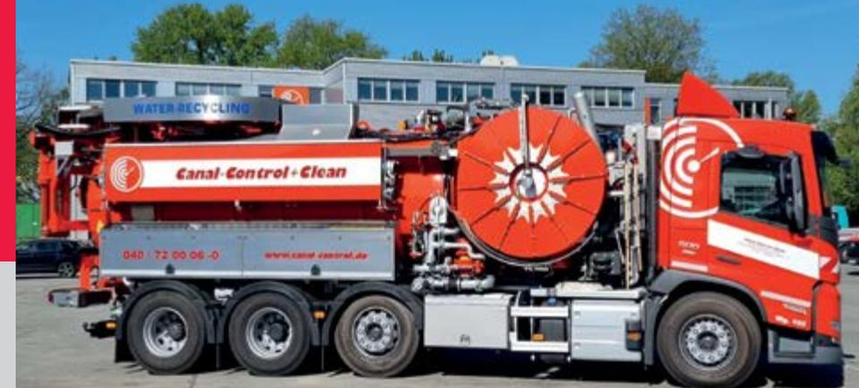
Kernmerkmale sind ein um 55% größeres Frischwasservolumen bei gleichzeitig höherer Nutzlast. Zudem ermöglicht die neue KAISERtronic-Steuerung eine signifikante Reduzierung des Treibstoffverbrauchs und der Geräuschemissionen. Erreicht wird dies mit einer bedarfsorientierten Leistungsregelung der Motordrehzahl optimal abgestimmt auf die gewünschte Reinigungsleistung.
